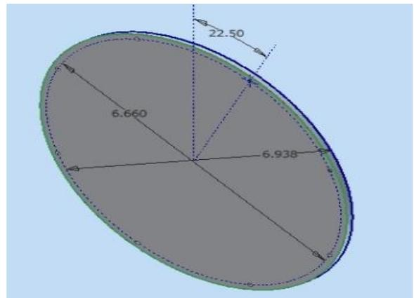
Fig. 3: Displacer piston
