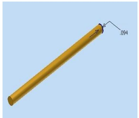
Fig. 17: Displacer Rod
